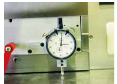
ダイヤルゲージで上面カッターの高さ調整も簡単
